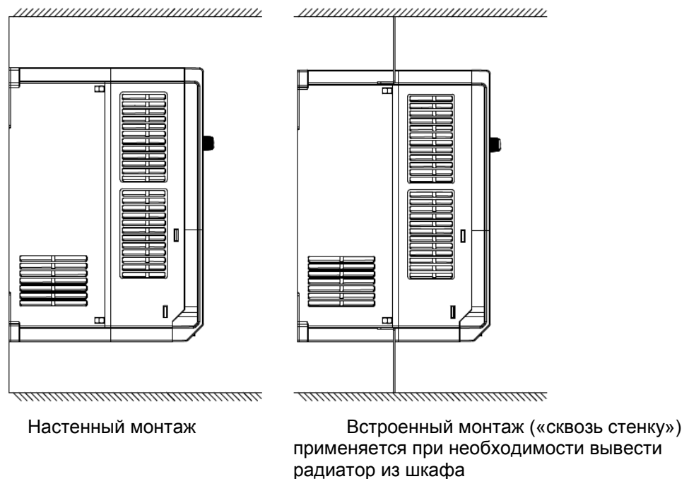
Рис. 3-1. Способы монтажа ПЧ
